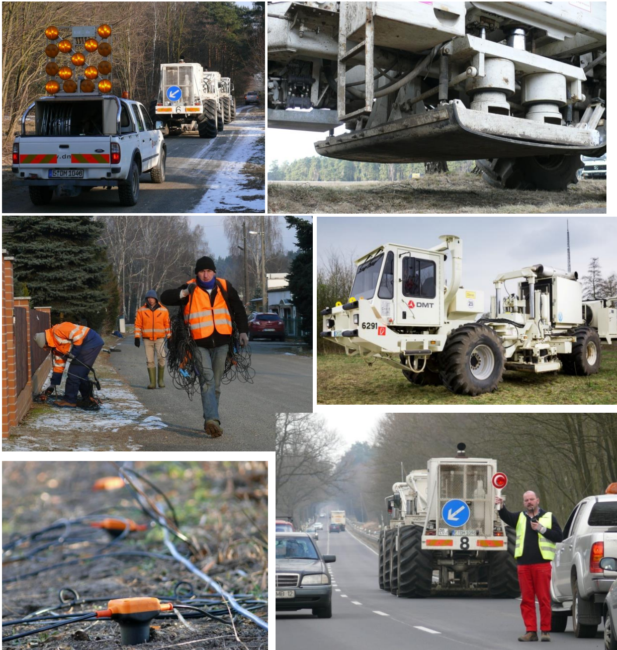
Abb. 3– 8 (von links nach rechts): Vibroseiszug mit Sicherungsfahrzeug, Vibrationskissen, Ausbringen von Geophonlinien, Vibroseis-Fahrzeug, Geophone, Verkehrsregelung auf Landstrasse.
